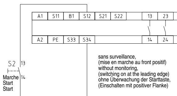
**Schéma de raccordement pour XPS-AS**
