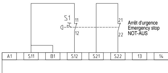
Raccordement de plusieurs boutons arrêt d'urgence
